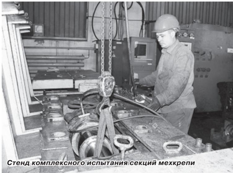
Стенд комплексного испытания секций мехкрепи
