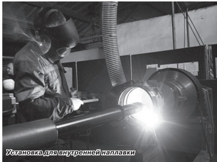
Установка для внутренней наплавки
